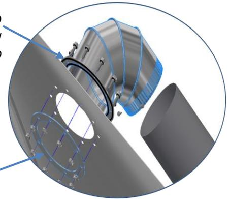
Соедините части трубы шурупами саморезами 60887 #10 x3/4" (1,9 см)
