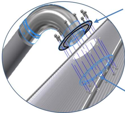
Нанесите уплотнитель на каждую сторону отверстий на стороне Elbow Flange на панели крыши. Как показано черным на рисунке.
